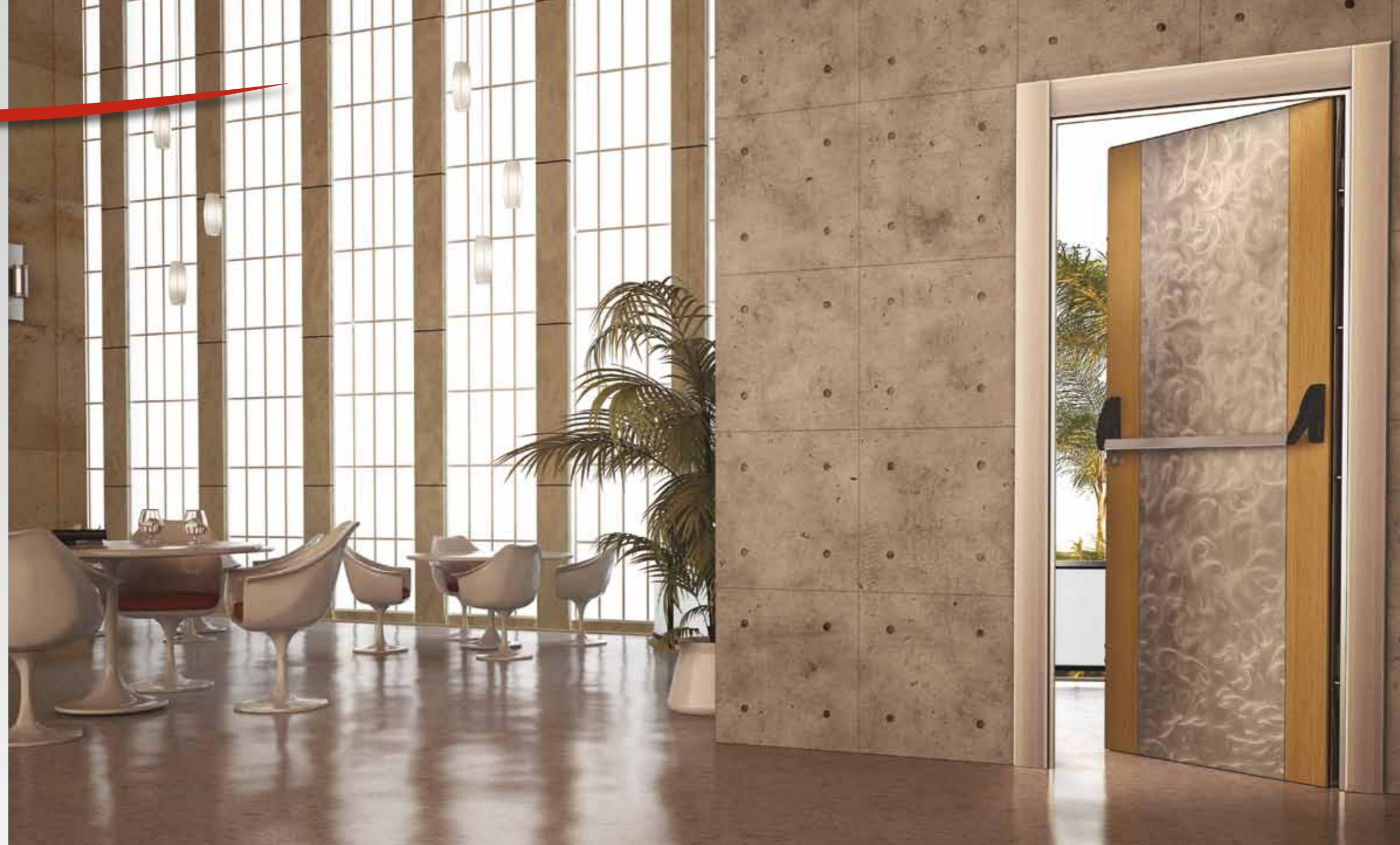
La porta blindata 1 anta mod. ANTIPANICO ha la serratura azionata con cilindro a profilo europeo e 12 punti totali di chiusura tra anta e telaio. La serratura, oltre al normale funzionamento a chiave, ha il maniglione per l'apertura rapida a spinta della porta. Premendo il maniglione la porta si apre anche se la serratura è chiusa non solo con lo scrocco ma anche con tutte le mandate.
